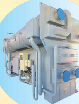
۴ - چیلر جذبی ۲ مرحله ای بخار ( بخار 6-8 Bar )
